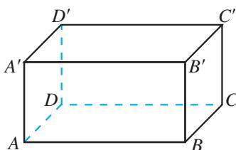
画几何体的直观图时,如果不作严格要求,图形尺寸可以适当选取.用斜二测画法画图的角度也可以自定,但要求图形具有一定的立体感.
